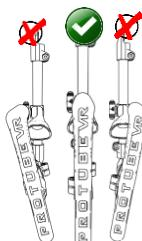
Règle le tube moyen avec le dessus de la crosse et visse plus fermement la vis.
