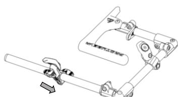
Puis remets le sur le tube et reserre la vis papillon (pas trop, tu auras probablement besoin de réajuster le support magnétique plus tard).
