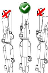
Règles le tube long avec la partie avant de la crosse et visse plus fermement la vis.
