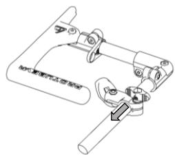
Desserre la vis papillon et enlève le support magnétique en le faisant glisser.
