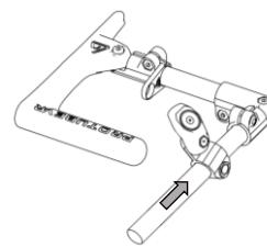
Puis remets le sur le tube et reserre la vis papillon (pas trop, tu auras probablement besoin de réajuster le support magnétique plus tard).
