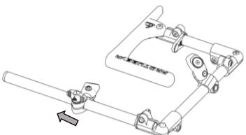
Desserre la vis papillon et enlève le support magnétique en le faisant glisser.
